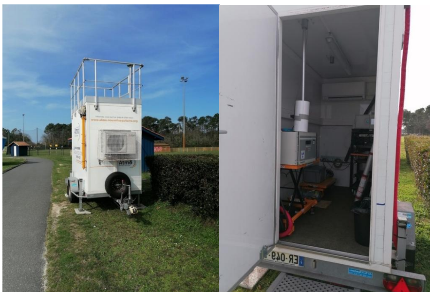
Figure 4 : station de mesure mobile implantée sur le site de la plaine des sports de Bonneval (à gauche) et vue intérieure des analyseurs automatiques de \text{NO}_2 et \text{PM}_{10} (à droite).
