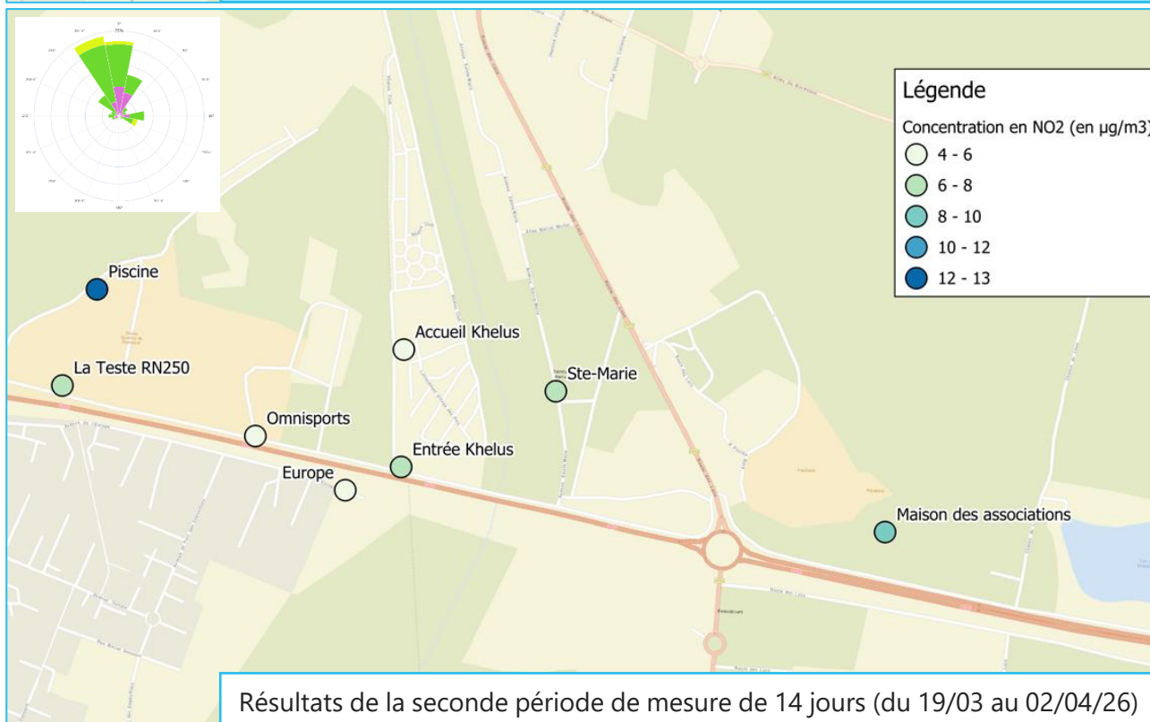
Figure 16 : résultats des mesures de NO 2 par tubes à diffusion passive
