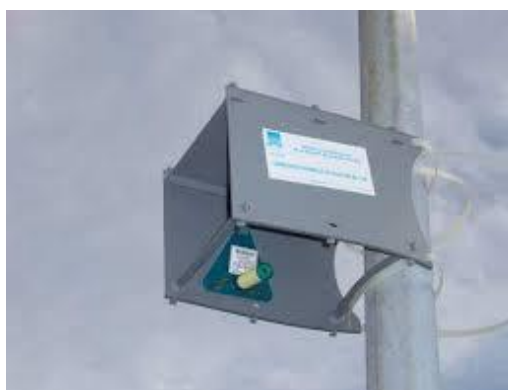
Figure 3 : tubes passifs mis en œuvre dans l'étude
