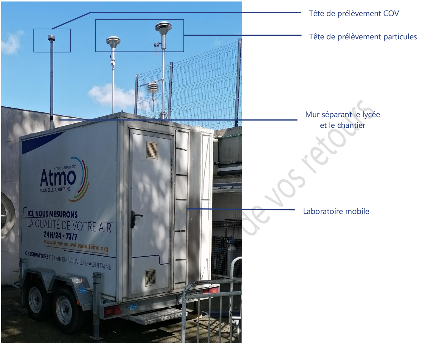
Figure 1: Photo annotée des moyens de mesure installés sur la cabine de mesure dans la cour de l'ensemble scolaire Fénelon
