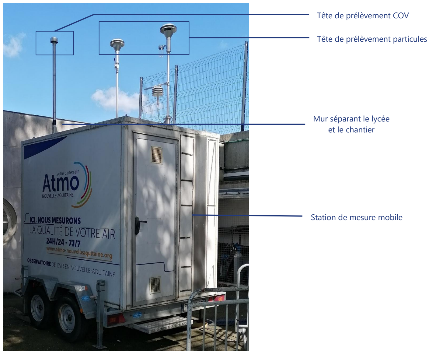
Figure 1: Photo annotée des moyens de mesure installés sur la station de mesure mobile dans la cour de l'ensemble scolaire Fénélon
