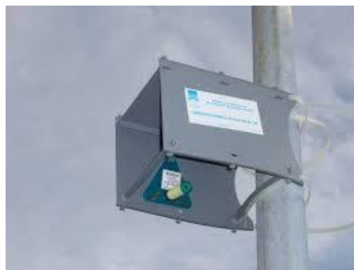
Figure 7 : tubes passifs mis en œuvre sur le site « Bouthier »
