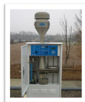
Préleveur dynamique bas volume (type Leckel)
