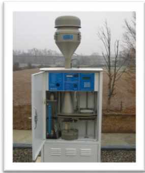
Préleveur dynamique bas volume (type Leckel)
