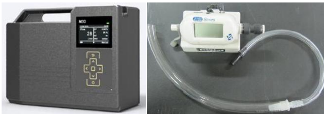
Figure 5. Pompe de prélèvement des pesticides dans l'air et débitmètre de vérification.
