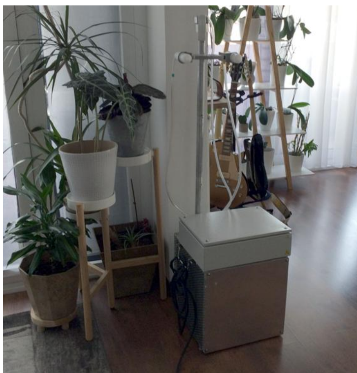
Figure 6. Caisson insonorisé abritant la pompe de prélèvement des pesticides dans l'air et celle de prélèvement des COSV et portoir de fixation des cartouches URG à une hauteur de 1m20.
