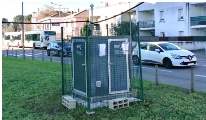
Une cabine mobile a été installée au niveau de l'avenue de Magudas à Mérignac, contenant des analyseurs mesurant en continu plusieurs polluants réglementés : les particules grossières PM<sub>10</sub> ainsi que les oxydes d'azote (NO<sub>X</sub>).
