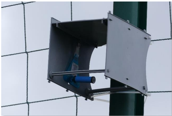
Figure 5 | Tube à diffusion passive dans sa boîte de protection contre les intempéries
