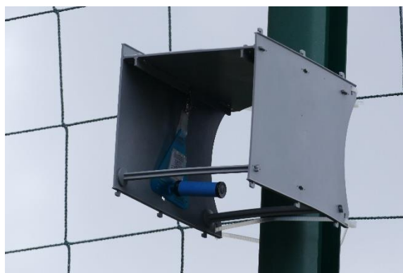
Tube à diffusion passive dans sa boîte de protection
