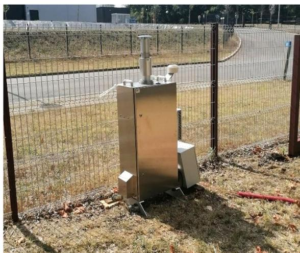
Figure 5 : préleveur de métaux installé sur le site "Ampère"
