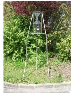
Figure 4 : jauge de prélèvement des retombées atmosphériques (en verre)
