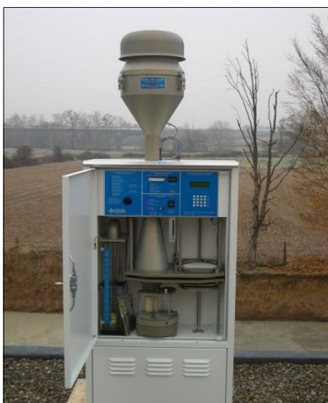
Avant mise en exploitation, les jauges OWEN et les PUF ont été conditionnées en laboratoire d'analyses Micropolluants technologie SA (4, rue de Bort-lès-Orgues, ZAC de Grimont / BP 40 010, 57 070 SAINT JULIEN-LES-METZ) accrédité COFRAC Essais 17025 (nettoyage, préparation, mise en conditionnement), afin d'avoir des prélèvements non influencés par l'environnement externe à la mesure. L'analyse de chaque prélèvement a été réalisée suivant les normes en vigueur par ce même laboratoire.
