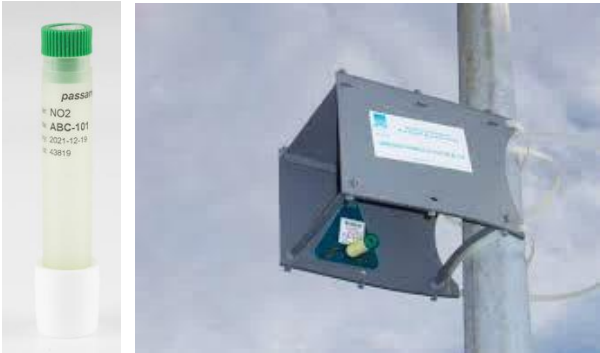
Figure 5 : tubes à diffusion passive NO 2 (à gauche) et boîte de protection contre les intempéries (à droite)
