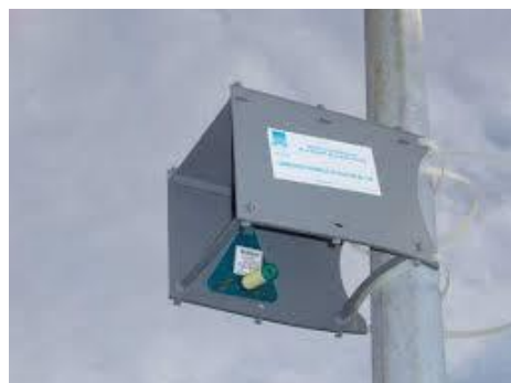
Figure 7 : boîte de protection contre les intempéries
