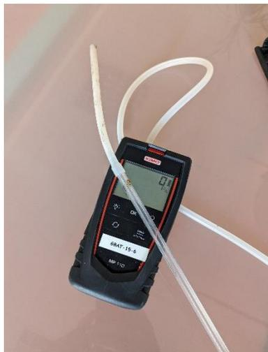
Micromanomètre portable avec capteur de pression intégré.
