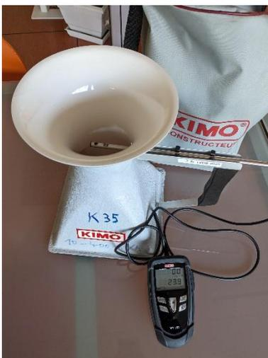
Mesure de vitesse et débit d'air au fil chaud.
