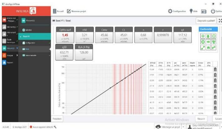
Le logiciel Infiltréa permet d'évaluer l'étanchéité à l'air de l'enveloppe des bâtiments selon la norme NF EN ISO 9972 et son guide d'application FD P50-784.
