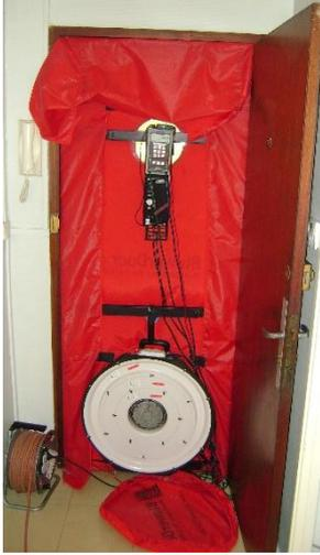
Le système de mesure Minneapolis BlowerDoor possède une plage de mesure de 19 à 7.200 m³/h.
