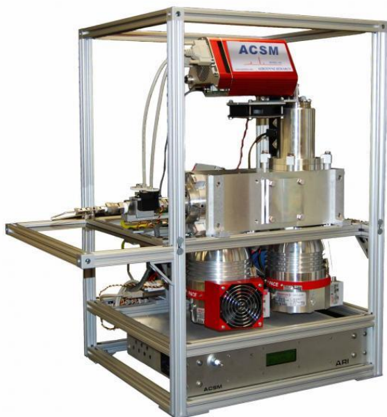
Figure 4 | ACSM, Photo d'un spectromètre « Aerosol Chemical Speciation Monitor »
