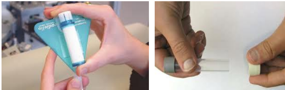
Figure 6 : tubes à diffusion passive ( \text{SO}_2 à gauche, \text{NO}_2 à droite)
