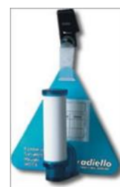
Figure 6 : tube à diffusion passive de type Radiello
