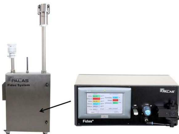
Figure 4 | Fidas, Photographie du granulomètre
