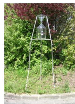
Figure 3 : jauge de prélèvement des retombées atmosphériques (en verre)
