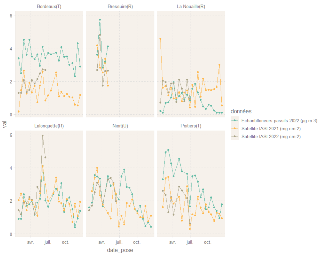
Figure 11 : concentrations NH 3 mesurées par échantillonneurs passifs et par satellites
