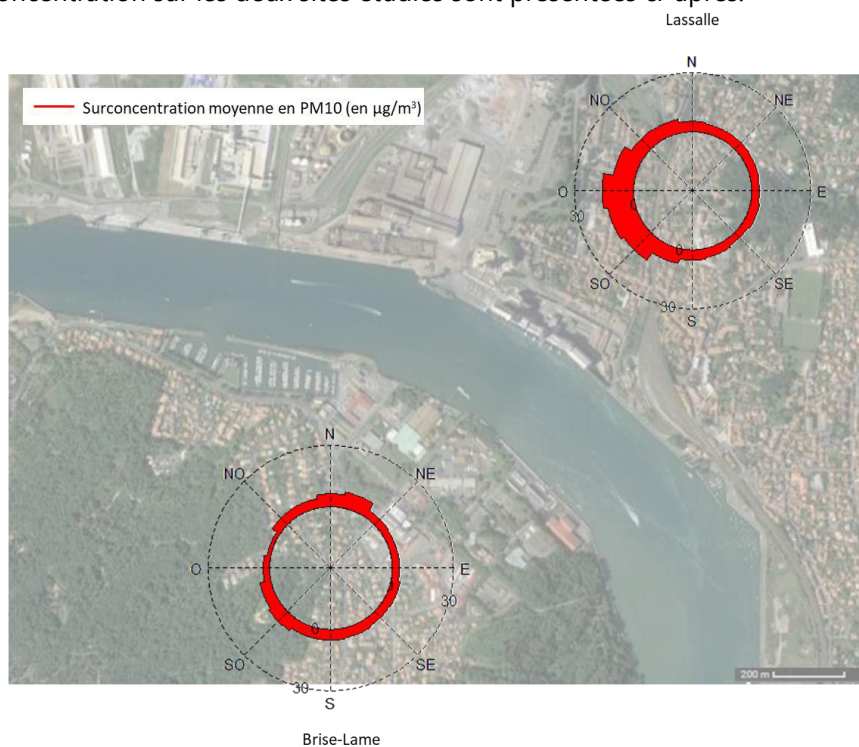
Figure 36 : Roses de surconcentrations moyennes des PM10 (en \mu\text{g}/\text{m}^3 ) par rapport à Bayonne (site de fond urbain) pendant la campagne automnale
