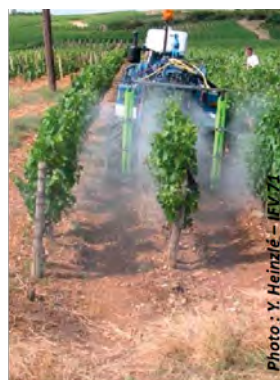
Buses à turbulence classiques
