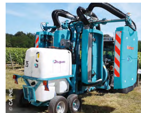
Tunnel de traitement
