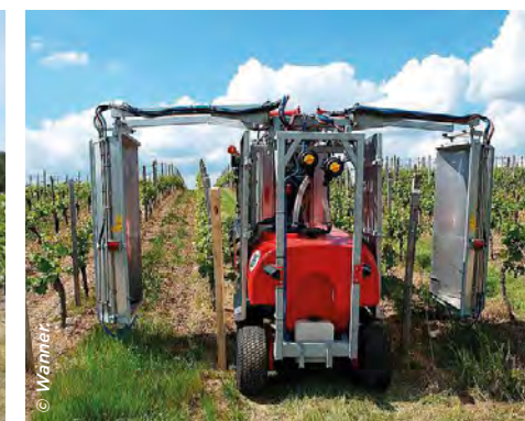
Pulvérisateur à jet porté à panneaux récupérateurs
