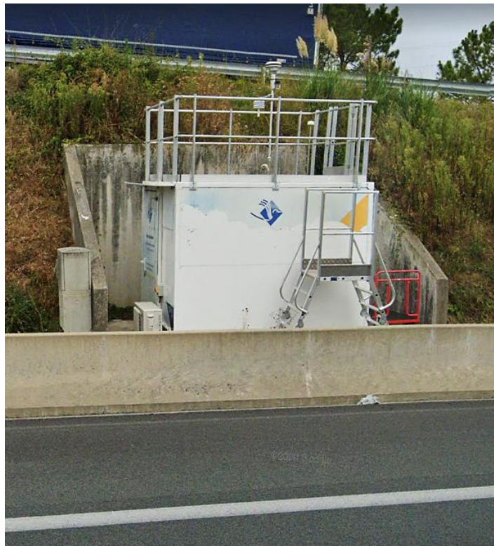
Figure 2 : cabine de mesure contenant les appareils de mesure de la qualité de l'air (source : Google Street View)
