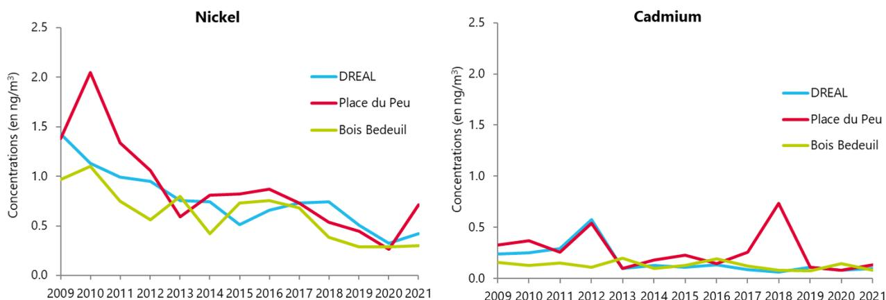
Figure 8 : Evolution des concentrations en Nickel et Cadmium depuis 2009 sur les 3 sites de mesures
