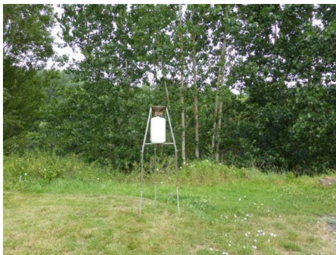
Figure 1 : jauge de prélèvement des retombées atmosphériques
