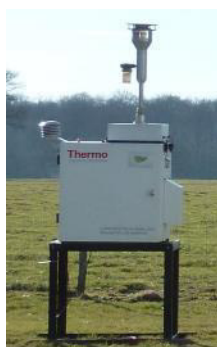
Figure 7 : préleveur dynamique à bas débit de métaux lourds en situation
