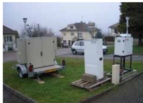
Analyseurs de SO 2 et PM 10 sur remorque Préleveurs de métaux lourds et de dioxines/ furannes
