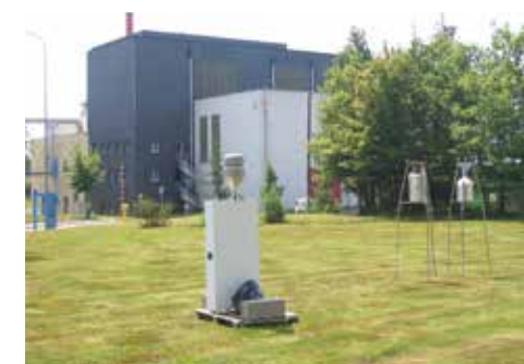
Prélèvements de métaux lourds et de dioxines/furannes dans les retombées atmosphériques et en air ambiant sur le site de l'UVE de Rosiers d'Egletons
