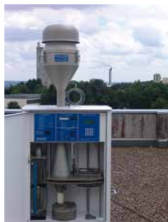
Préleveur de métaux lourds et de dioxines/furannes en air ambiant sur le site de Beaubreuil à proximité de la CEDLM
