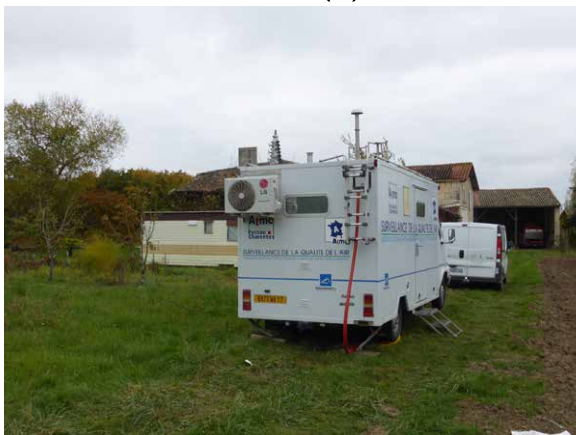
Mesure de composés odorants près du Pôle Déchets de Calitom à Ste-Sévère (16)
