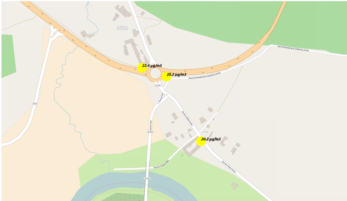
Illustration 5: Résultats des mesures par échantillonneurs passifs (zoom intersection D144 et N141)
