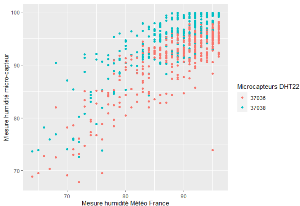
Figure 37 : nuage de points des moyennes horaires d'humidité mesurées par les 2 capteurs DHT22 de Périgny et la station Météo-France de La Rochelle-Laleu
