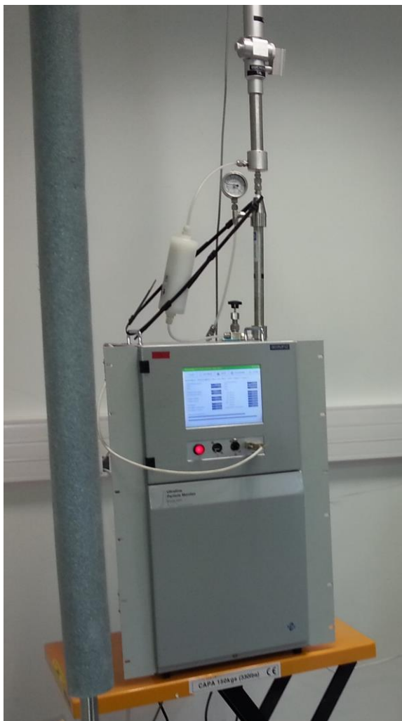
Figure 1 : Granulomètre UFP 3031 - Principe de fonctionnement
