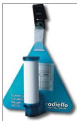
Illustration 1.3 : Exemple de tube à diffusion passive
