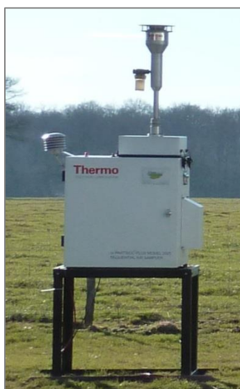
Illustration 1.4 : Préleveur dynamique à bas débit en situation sur le site « La Caure du Bost »
