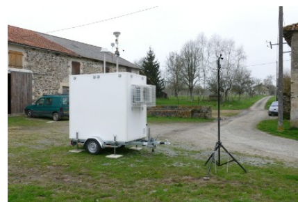
Illustration 6: Analyseur en situation dans le laboratoire sur remorque
