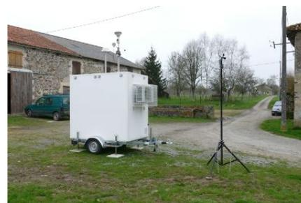
Illustration 6: Analyseur d'H<sub>2</sub>S et de PM<sub>10</sub> en situation dans le laboratoire sur remorque
