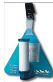
Illustration 3 : Exemple de tube à diffusion passive
