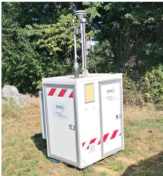
Figure 3 : laboratoire mobile installée pour la campagne « après travaux » du Tram'Bus
