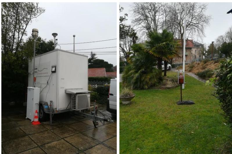
Figure 1 : laboratoire mobile et préleveur haut volume (à gauche) ; jauge de dépôt (à droite)
