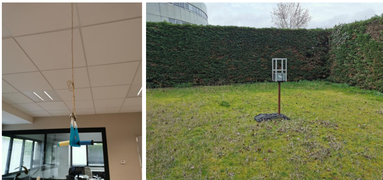
Figure 2 : tubes passifs sur site à l'intérieur (à gauche) et à l'extérieur (à droite)
