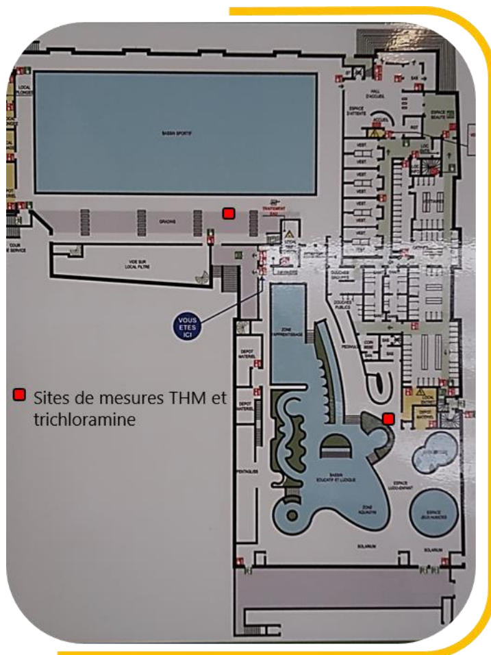
Figure 1 : Plan de la piscine et emplacement des points de mesure
