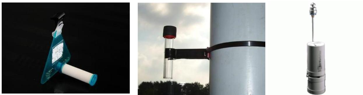
Figure 1 : tube à diffusion passive BTEX (à gauche, tube NO<sub>2</sub> (au centre), MicroVol (à droite)
