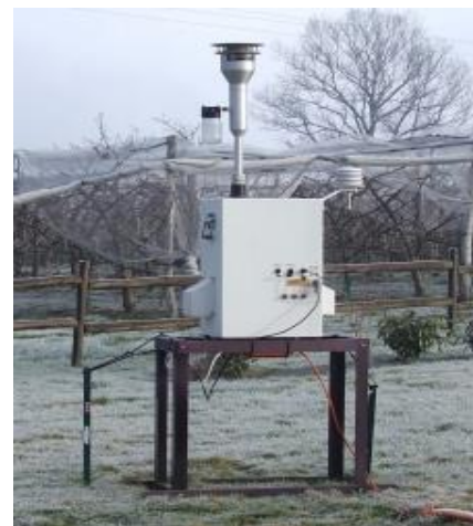
Figure 16 | Photographie d'un préleveur Partisol 2000
