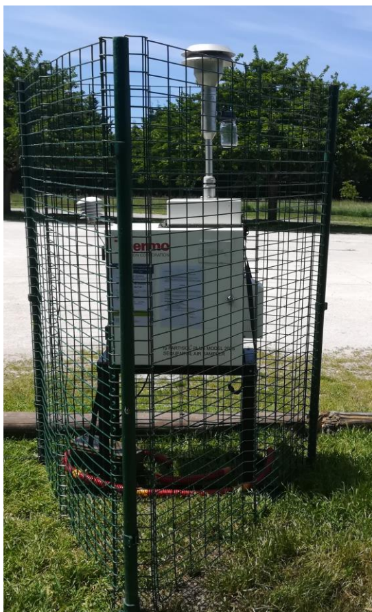
Figure 5 : Partisol installé à Parempuyre et descriptif de la méthode de prélèvement
