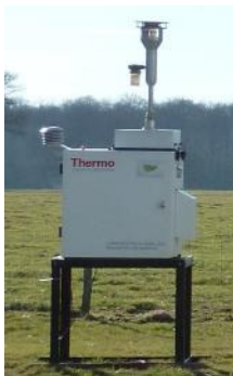
Figure 6 : Préleveur dynamique à bas débit de métaux lourds en situation
