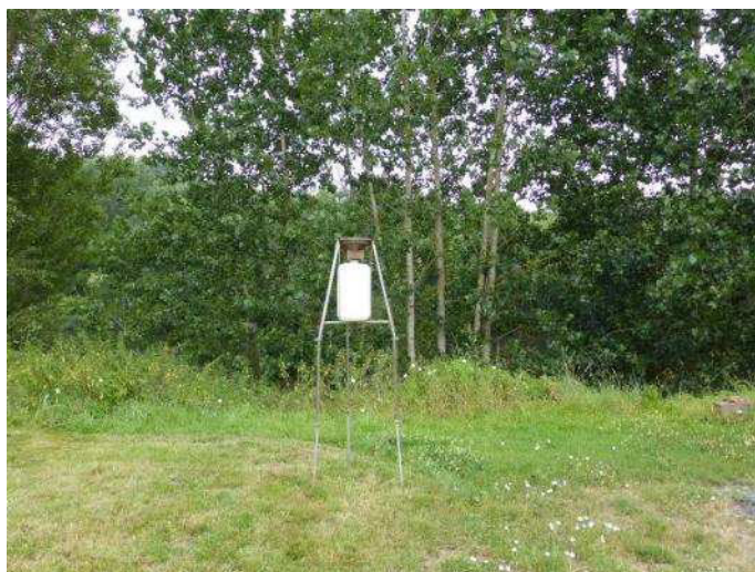
Figure 1 : jauge de prélèvement des retombées atmosphériques
