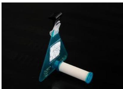
Figure 2 : tube à diffusion passive
