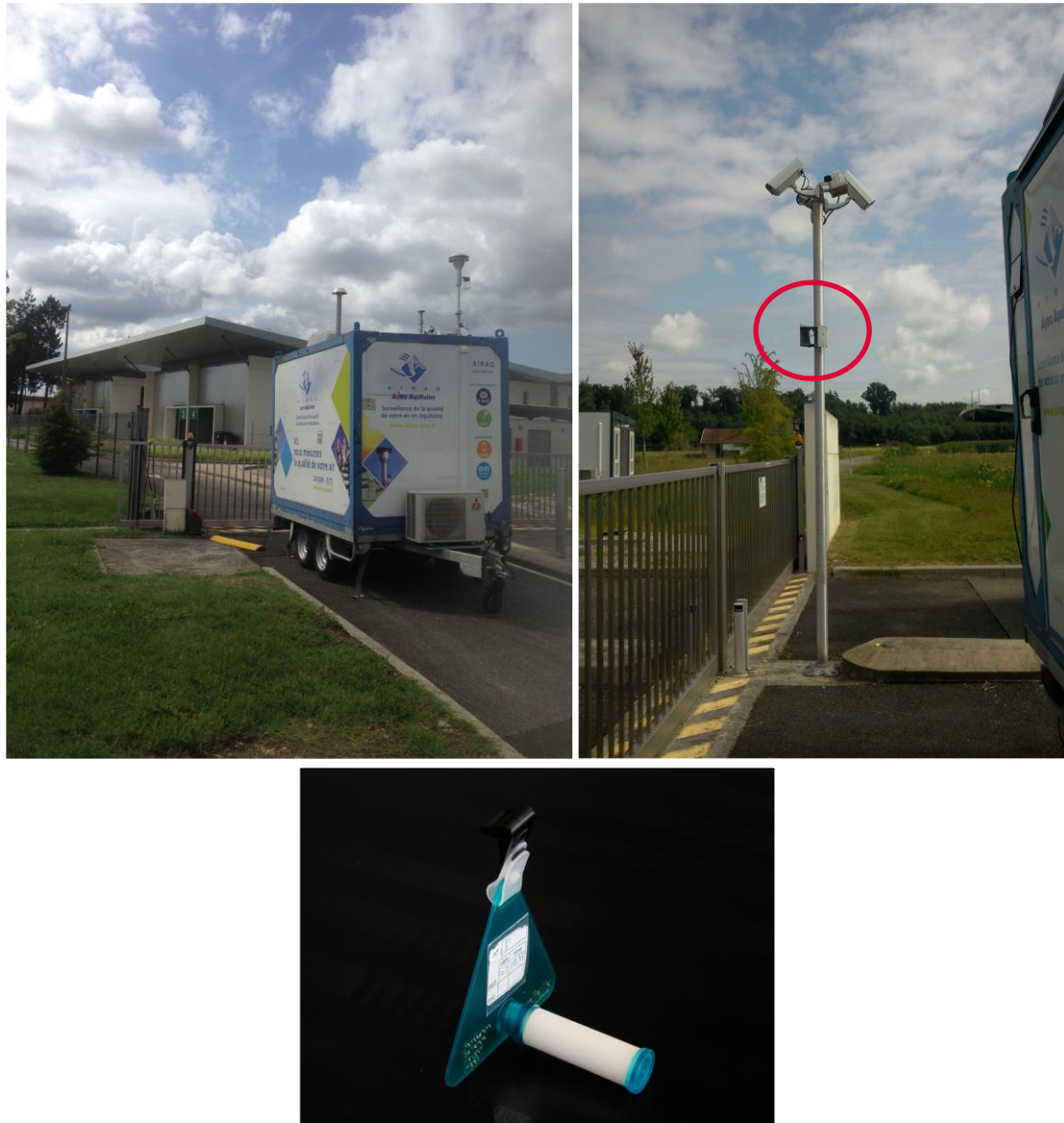
Figure 5 : photo du dispositif de mesures (le laboratoire mobile en haut à gauche ; les tubes à diffusion passive en haut à droite et en bas)
