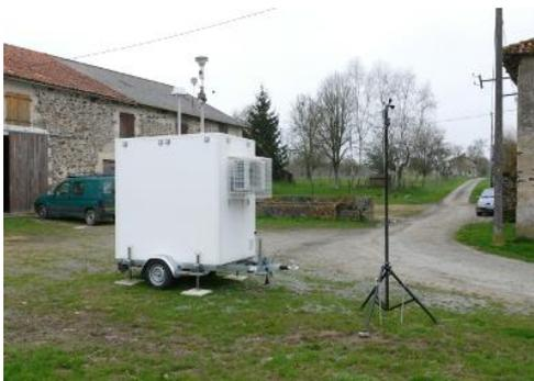
Figure 5 : Moyen mobile contenant les analyseurs automatiques
