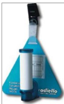
Figure 3 : Tube à diffusion passive
