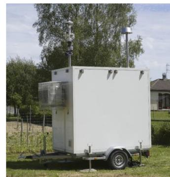
Figure 8 : Analyseur en situation dans le laboratoire sur remorque
